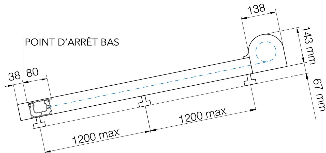
*Le store de véranda Prodotti est posé sur ses équerres ajustables positionnées sous les coulisses. Ainsi, le coffre maintenu en porte-à-faux par les coulisses, peut complètement être dégagé du vitrage, le rendant quasi invisible.*
