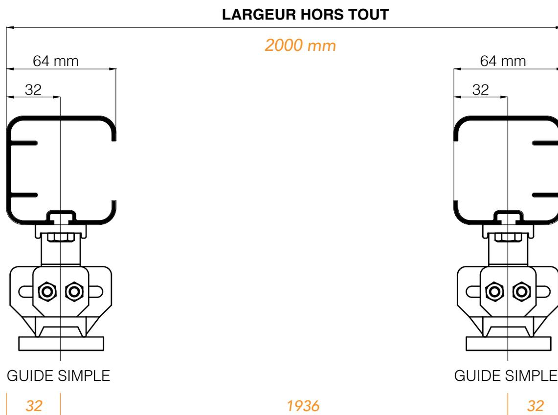
*Exemple : pour une largeur hors tout de 2000 mm, alors l'entre axes de pose est de :  $2000 - 64 = 1936$  mm*
